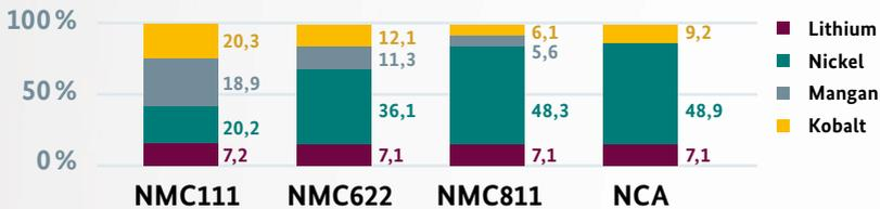
Abbildung 38: Rohstoffverhältnis in LIB mit verschiedenen Kathoden.
